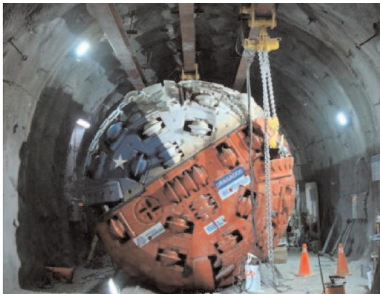
Fig. 8. Cabeza de corte de la TBM seleccionada.
