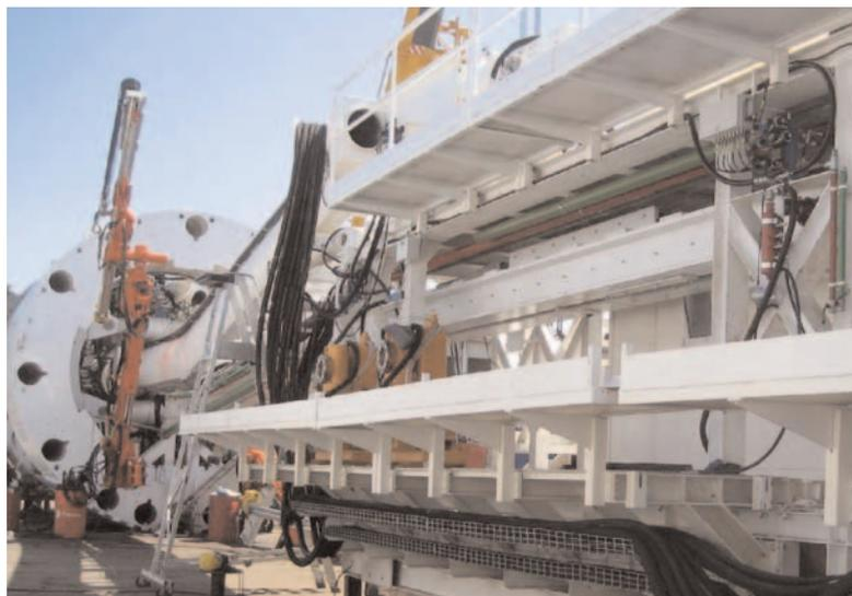
Fig. 13. Vista del brazo perforador de la TBM colocado sobre un erector giratorio
